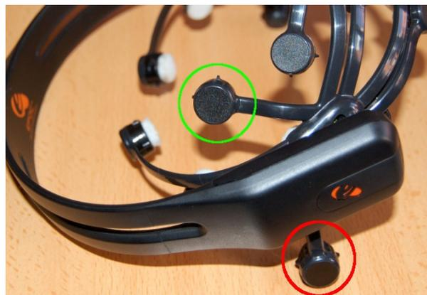
Figura 15: Detalle ubicación electrodos de referencia
